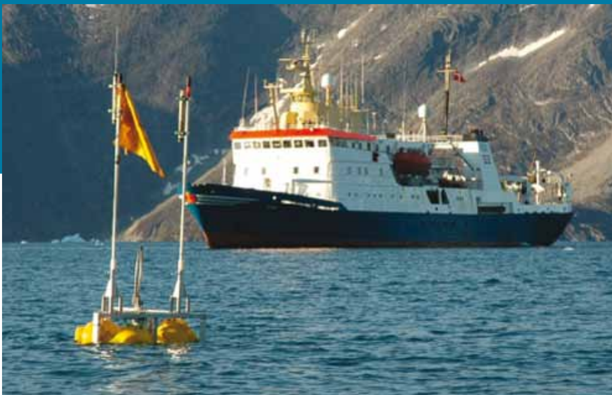
Havforskningskibet Dana i Godthåbsfjorden. Udstyret i forgrunden er en "lander" der netop er returneret til overfladen efter at have foretaget et detaljeret måleprogram på havbunden i 24 timer. FOTO SØREN RYSGAARD
